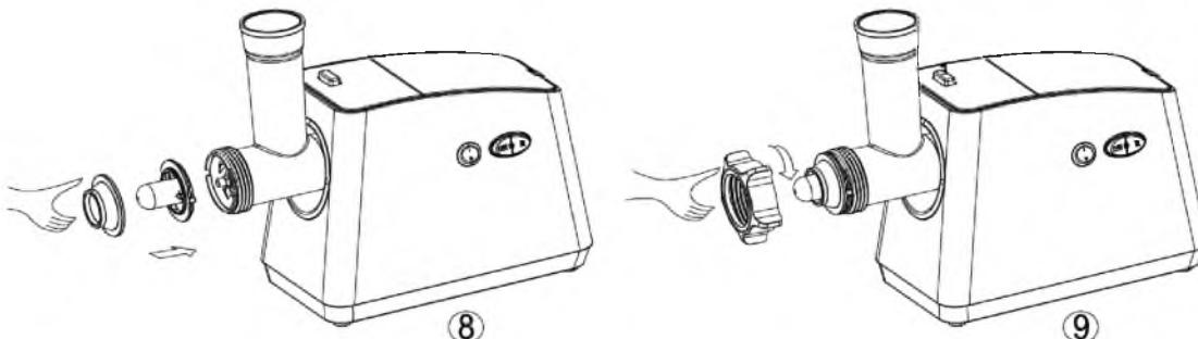
Зафіксуйте кільцевою гайкою (13) (Рис. 9)
